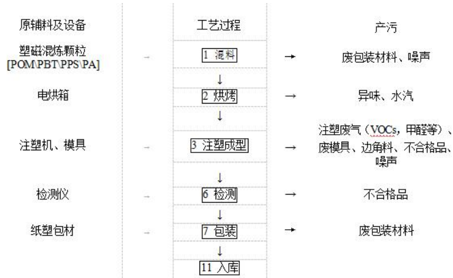
图 2-4 注塑磁体生产工艺流程及产污环节
